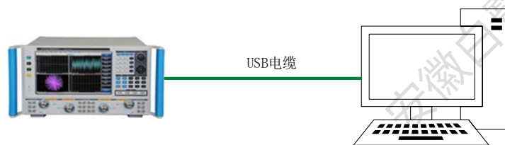
图 2-4 频谱分析仪通过 USB 连接示意图
