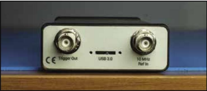
VSG60A 的外部 10 MHz 参考输入
