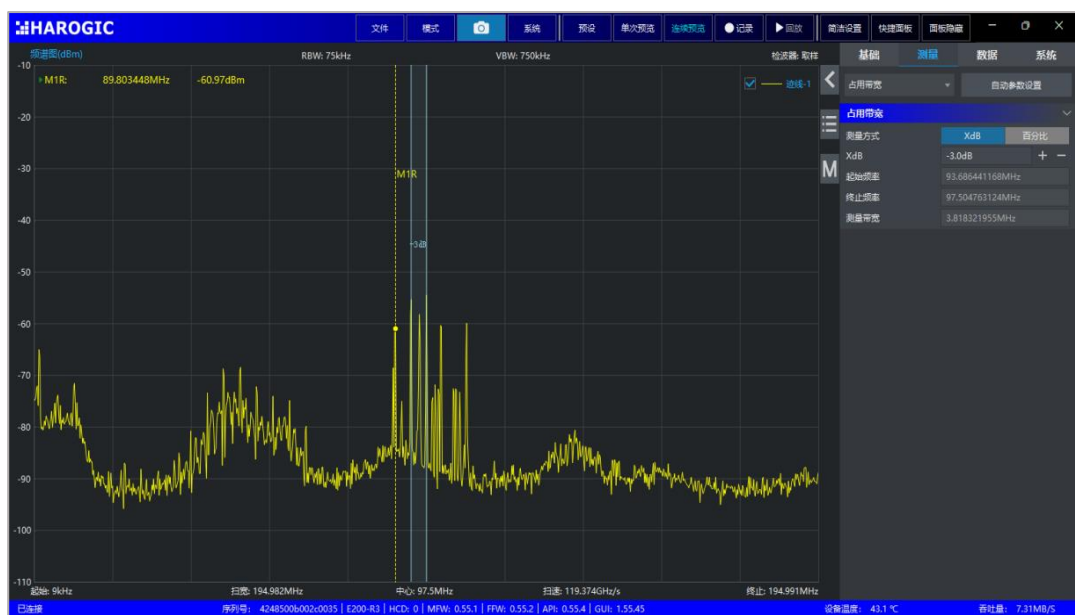
图 29 SWP 模式的占用带宽测量功能
