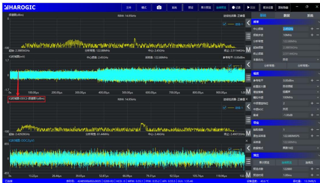
图 12 子 IQ 流可进一步开启频谱分析等计算节点
