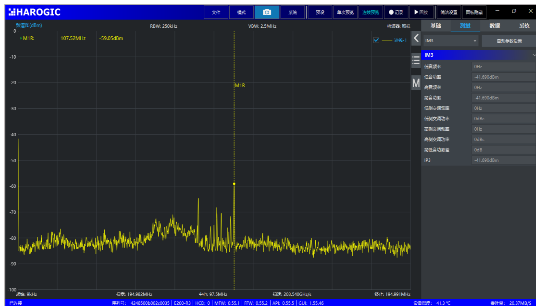
图 25 SWP 模式的 IM3 与 IP3 测量功能
