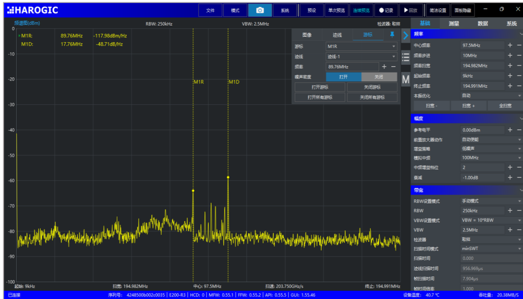
图 31 SWP 模式的噪声密度测量功能
