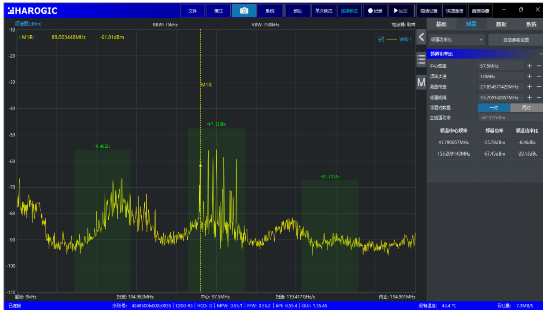
图 28 SWP 模式的邻道功率比测量功能
