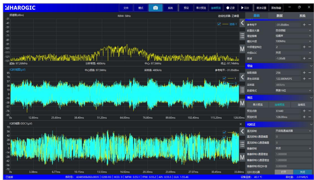
图 11 由原始 IQ 流通过 DDC 节点生成子 IQ 流
