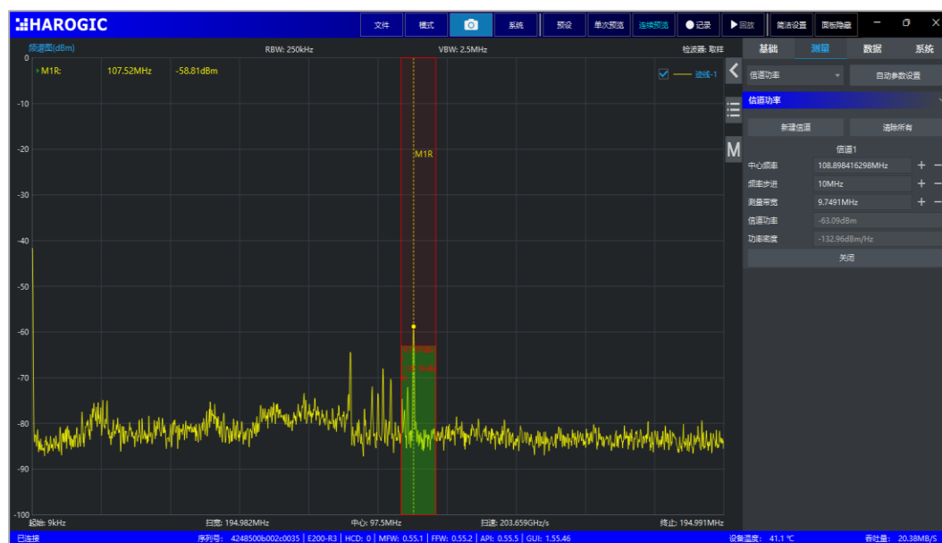
图 26 SWP 模式的信道功率测量功能
