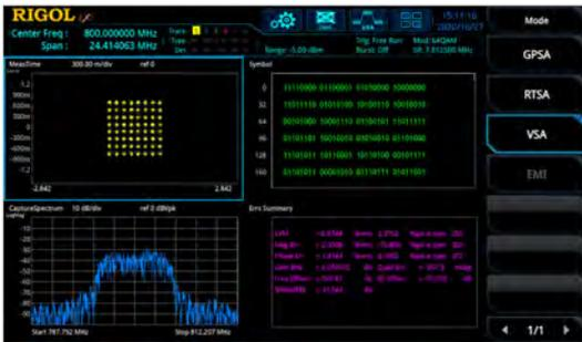
矢量信号分析功能 VSA 支持多种数字调制格式，如 QAM、PSK、MSK、ASK、FSK 等。通过该功能进行快速地解调，展示其星座图、眼图（基带信号）、频谱图、解调数据等多维数据，从而发现设计中存在的问题。
