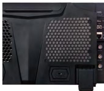
包括 USB Host&Device、LAN(LXI)、HDMI、TRIG OUT、USBPIB (选件)。示波器符合 LXI CORE 2011 DEVICE 类仪器标准。
