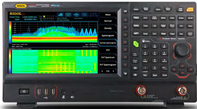
RSA5000 系列实时频谱分析仪，包含 RSA5065、RSA5065-TG、RSA5032、RSA5032-TG、RSA5065N、RSA5032N 六种型号，其中-TG 表示配备跟踪源功能，频段范围分别为 9kHz 至 6.5GHz、9kHz 至 3.2GHz。RSA5000 系列标配扫频 GPSA 模式和实时 RTSA 模式，是一台具有超高性价比的频谱分析产品。
