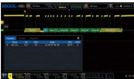
区域触发可以结合其他 20 种触发类型一起使用，还同时支持解码、波形录制和通过测试功能，对于复杂信号的调试起到事半功倍的效果。
