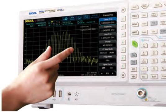
您可以使用 RSA3000 提供 10.1 英寸多点触控电容屏进行快速的设置，并支持对波形进行拖动、展开、缩放等多种手势操作，提供人性化交互体验，最大程度节约您的时间。
