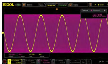
全内存硬件测量可以同时观察并准确测量两路频率相差很大的信号。
