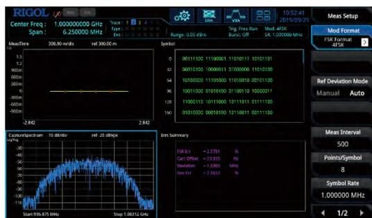
ASK/FSK 解调分析软件帮助工程师对 TPMS、PKE/RKE 等信号进行解调分析, 得到信号调制质量的参数, 帮助产品快速上市。
