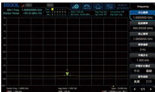
微弱信号的测试容易受到频谱仪本身的本底噪声影响。RSA3000 系列显示平均噪声电平低至 -161 dBm，可以有效保证对微弱信号的测试能力。
