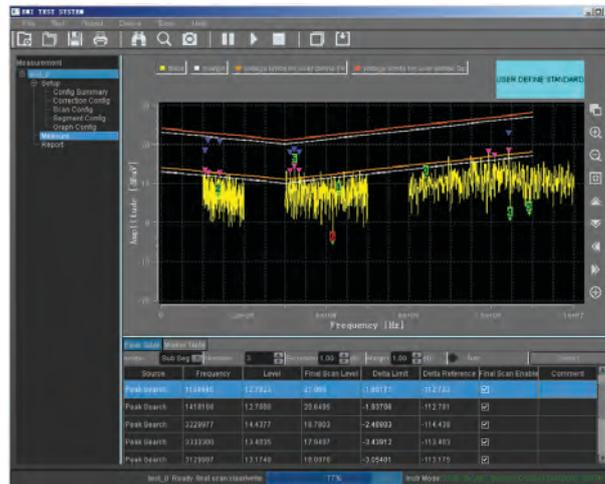
EMI Test System 软件是针对具有 EMI 功能的 RSA5000、RSA3000/E 和带 EMI-DSA800 选件的 DSA800 系列、DSA800E 系列、DSA700 系列频谱分析仪开发的一款 PC 应用软件。用户可以使用 EMI Test System 软件<sup>[1]</sup> (S1210) 并结合 RIGOL RSA/DSA 系列频谱分析仪进行传导和辐射的干扰测试。电源线上的干扰电压可以用线性阻抗稳定网络 (LISN) 进行测量；辐射干扰则可通过自动加载校正因子 (天线、电缆、其他或用户) 对结果进行幅度校正。
