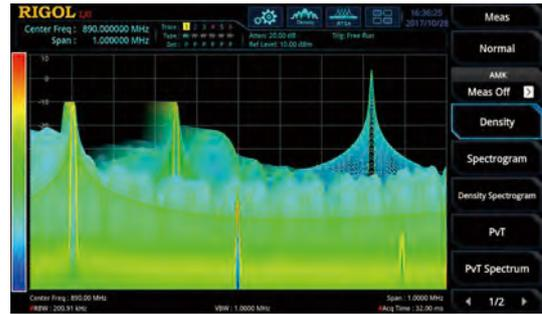
RSA5000 运用独创的 Ultra Real 技术，提供高达 40 MHz 的实时带宽。在实时带宽范围内，可以保证超过 7.45 us 持续时间的瞬态信号可被 100% 捕获并准确测量。
