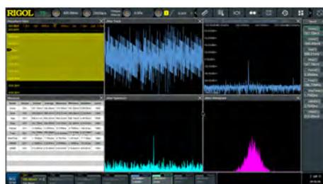
激活并购买 DS70000-JITTA 选件后，DS70000 系列支持所有模拟通道的眼图测量，同时提供多种眼图参数测量：眼高、眼宽、眼幅度、眼交叉比、Q Factor，并且支持多种时钟恢复方式，包括常数时钟（自动、半自动、手动）、一阶锁相环、二阶锁相环和外部时钟，可以满足客户不同的使用环境需求。
