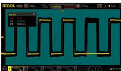
MSO8000/A 系列示波器标配硬件 Pass/Fail 测试功能，可应用于信号的长期监测、设计期间的信号监测和生产线上的测试。
