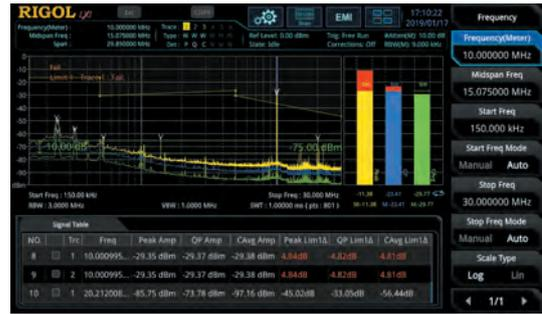
RSA3000 内置 EMI 预测试应用软件，结合符合 CISPR 标准的滤波器，对产品进行传导及辐射的预测试，从而发现其传导/辐射骚扰源并改善，加速产品上市。
