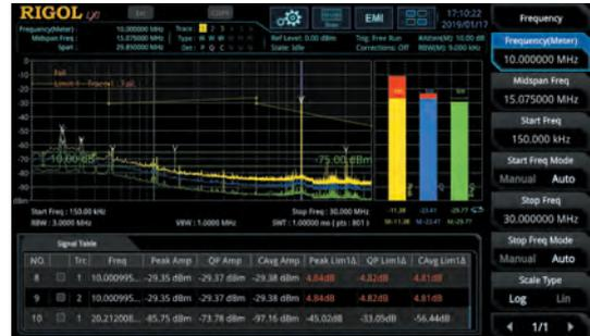
RSA5000 内置 EMI 预测试应用软件，结合符合 CISPR 标准的滤波器，对产品进行传导及辐射的预测试，从而发现其传导/辐射骚扰源并改善，加速产品上市。
