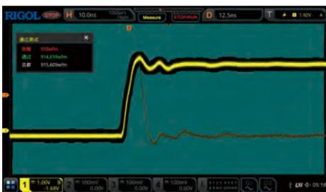
MSO7000/DS7000 系列示波器标配硬件 Pass/Fail 测试功能，可应用于信号的长期监测、设计期间的信号监测和生产线上的测试。
