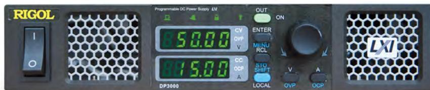
DP3000 系列属于高性能的可编程大功率直流电源，三种功率系列选择:750W、1500W 和 3000W，输出电压范围从 6V-600V，输出电流从 1A-400A。外型轻巧，1 U 半宽达 750 W (1UH 是全机架半宽)，1U 全宽达 1500W，2U 全宽达 3000W。标配 RS485 接口和 LXI(LAN)，或可选配 GPIB 接口/ISO 隔离式选项 (具备模拟信号控制以及监测功能)。
