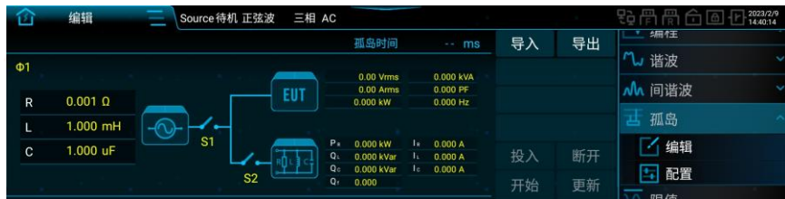
图 116 防孤岛测试功能界面图
