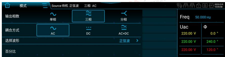
图 45 模式设置界面及输出设置区图
