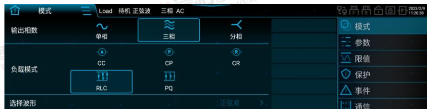
图 168 RLC 模式设置界面图
