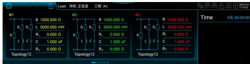
图 169 RLC 模式参数设置页面图
