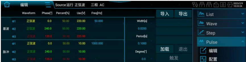
图 85 Pulse 编程界面图
