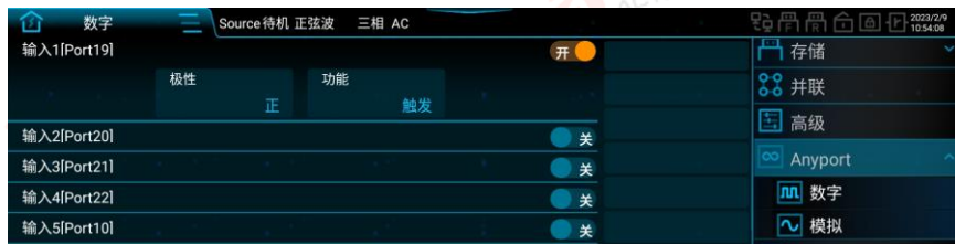
图 149 数字输入设置界面图
