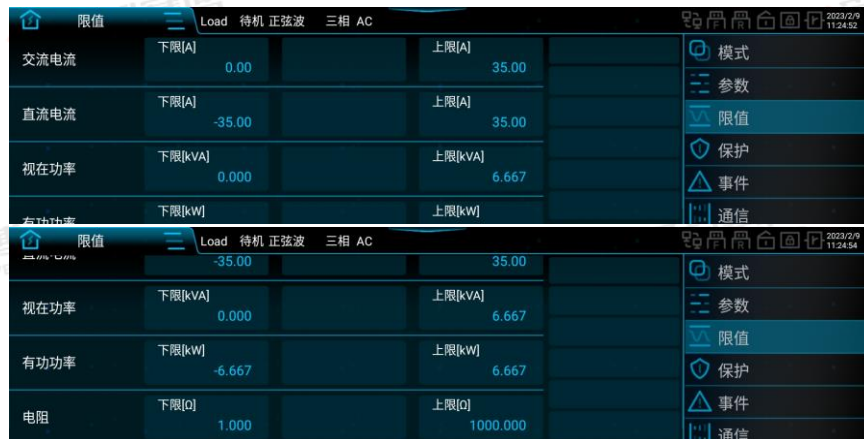
图 174 负载模式限值设置界面图
