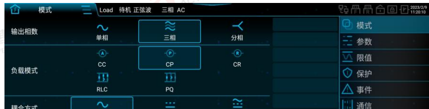
图 163 CP 模式设置界面图一
