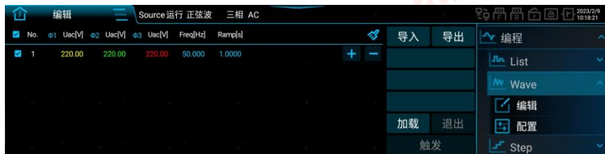
图 72 Wave 编程界面图
