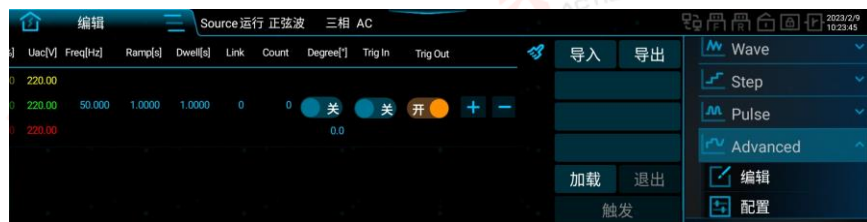
图 91 Advanced 编程界面图二
