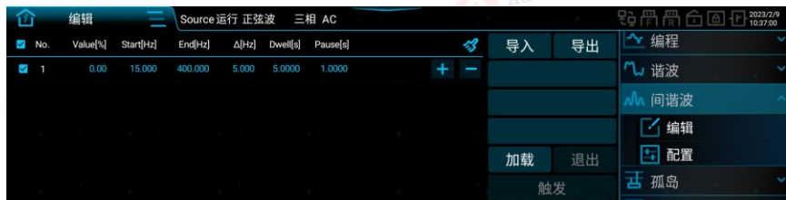
图 108 间谐波参数设置界面图
