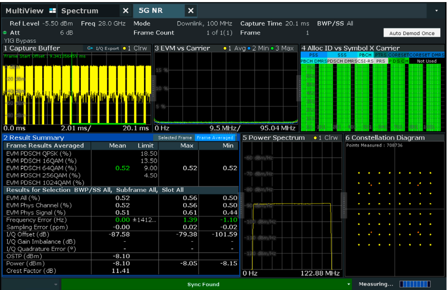
使用FSW-K144分析5G NR下行链路信号
