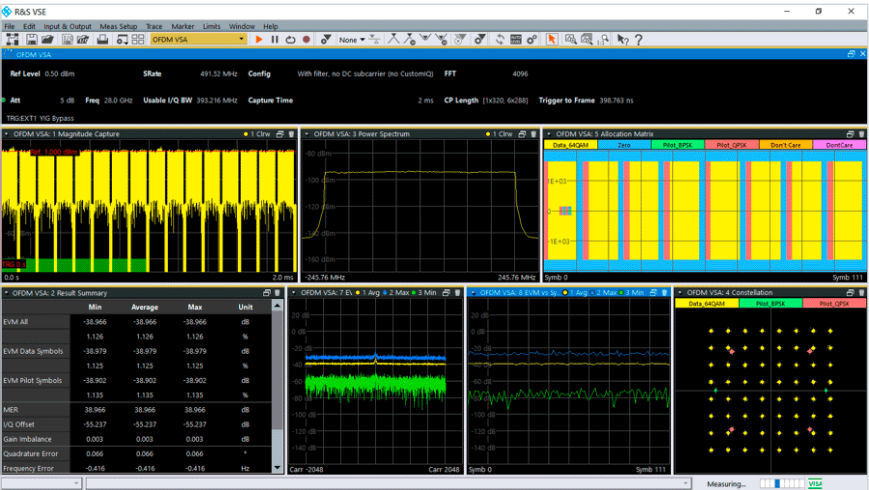
使用R&S®VSE-K96分析通用OFDM信号
